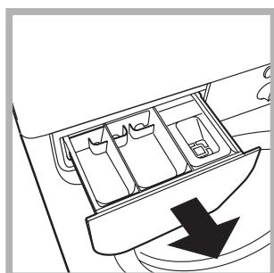
Wysunąć szufladkę, unosząc ją lekko ku górze i wyciągając na zewnątrz (*patrz rysunek*). Wypłukać szufladkę pod bieżącą wodą. Czynność tę należy wykonywać stosunkowo często.
